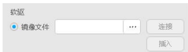
图 5-79 通过虚拟软驱挂载镜像文件
