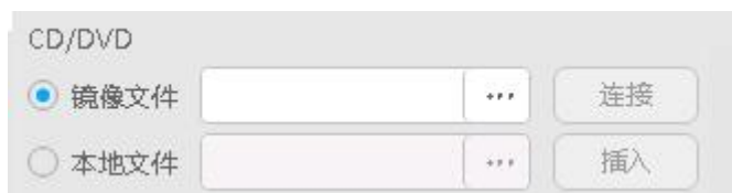
图 5-75 通过虚拟光驱挂载镜像文件
